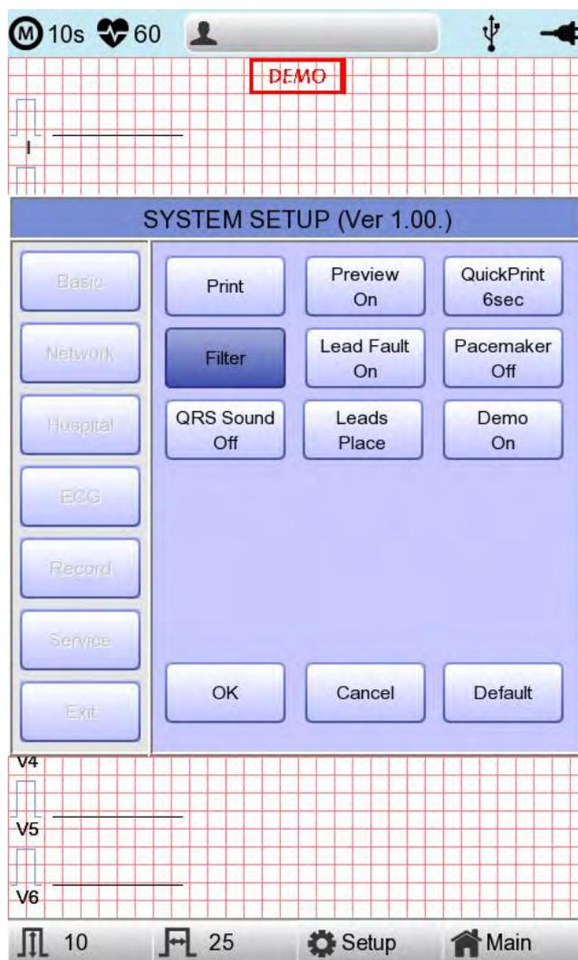
Nach der Auswahl wird das Filterkonfigurationsmenü, wie nachfolgend dargestellt, angezeigt. Navigieren Sie mithilfe des Drehreglers oder des Touchscreens durch die Menüoptionen und wählen Sie diese zur Bearbeitung aus. Nach dem Bearbeiten müssen Sie „OK“ auswählen, um den geänderten Wert zu übernehmen.
